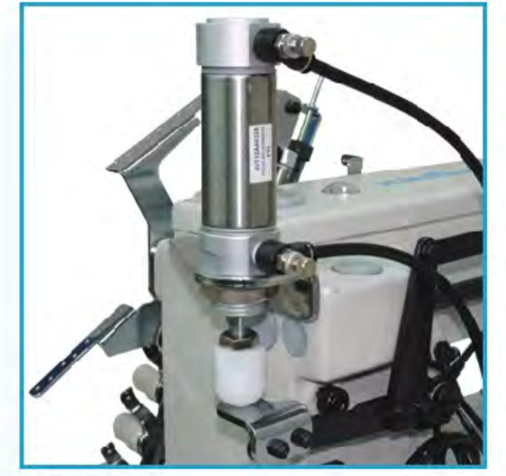
AL004 氣動式壓腳昇器 Pneumatic Presser Foot Lifter
