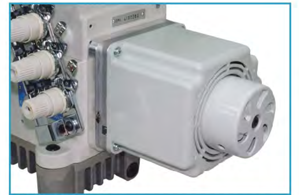
MTD4500 直驅式馬達 Direct drive servo motor
