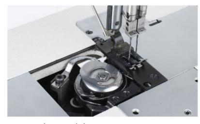
直刀切線機構設計,剪線穩定
